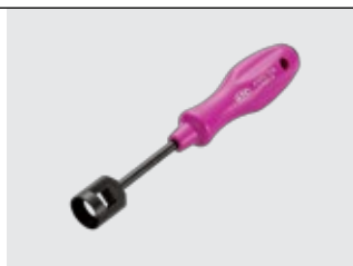
ABX-34 Shoe-Hold Spring Cup Tool ตัวกดปลดสปริงล๊อคฝักเบรค Ø10 ยาว 195 มม.
